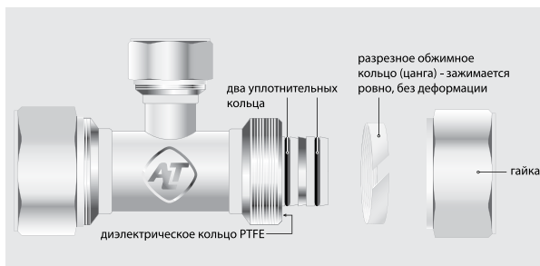
Рис. 1. Конструктивные элементы цангового фитинга
