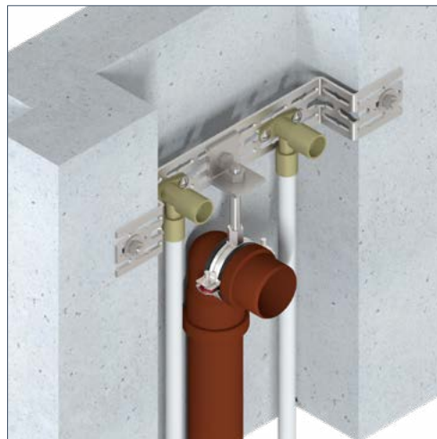
Комбинированное крепление водорозеток и канализационной трубы
