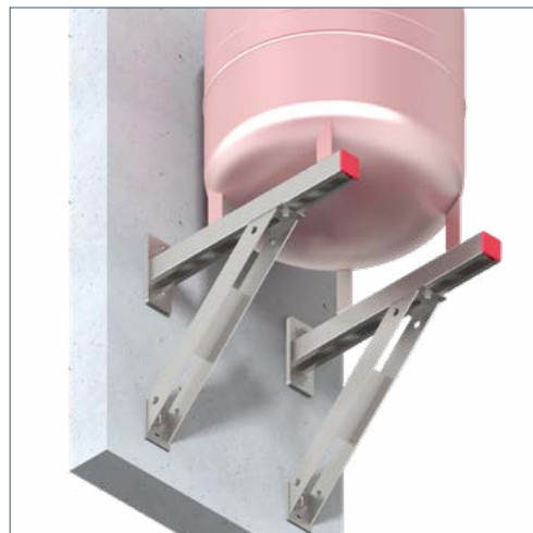
Крепление расширительного бака на консольных вылетах
