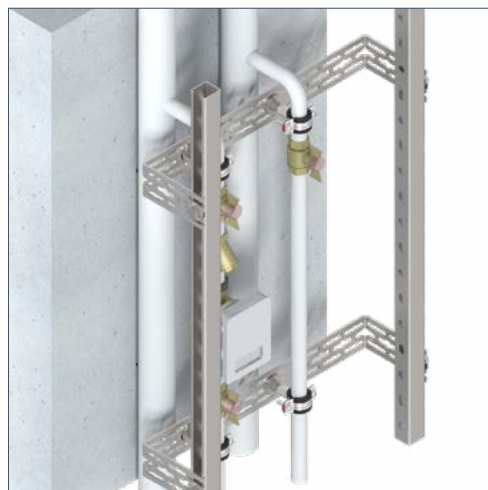
Крепление обвязок к элементам несущего каркаса
