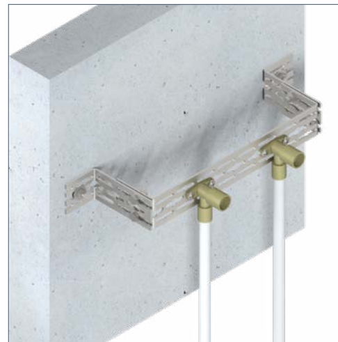
Регулировка положения и фиксация водорозеток
