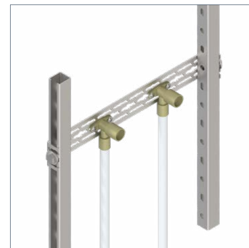
Крепление водорозеток к элементам несущего каркаса
