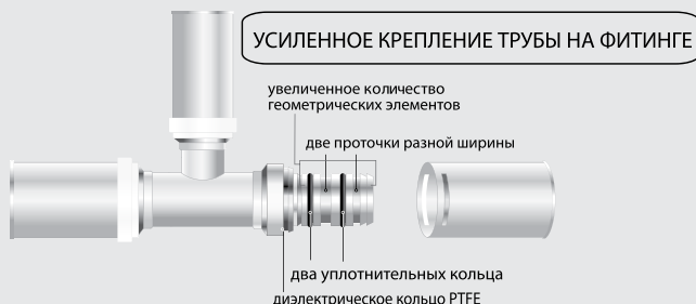
Рис. 1 Конструктивные элементы пресс-фитинга
