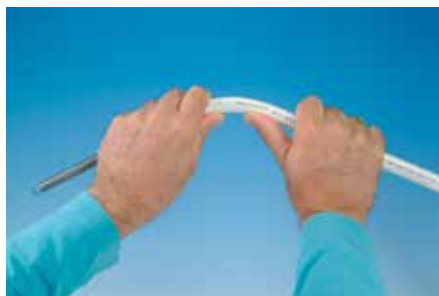
Гибка с помощью внутренней гибочной пружины
